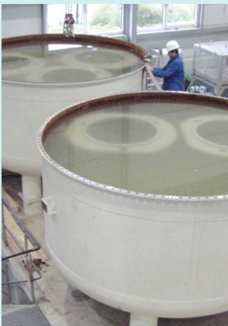
Wassersättigung von Schachtelementen
