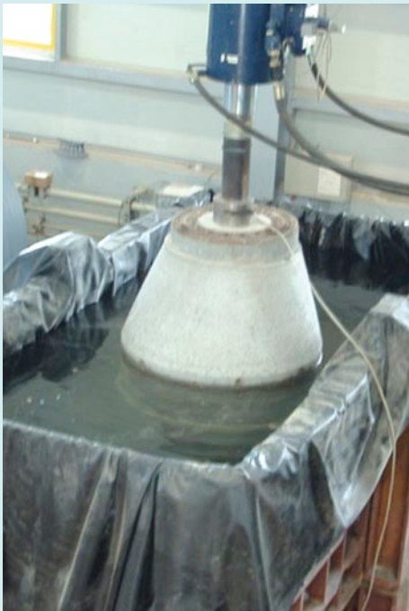
Dynamische Belastung eines beschichteten Schachtes
