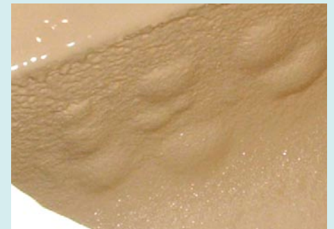
Blasen in einer Beschichtung aus Polyurethan bei hohem Feuchtegehalt des Untergrundes
